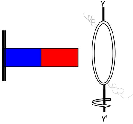
تدور الوشعة حول المحور (Y'Y) بفعل الطاقة الميكانيكية أمام المغناطيس الثابت وبفعل حركة الوشعة ينتج فيها تيار كهربائي .
