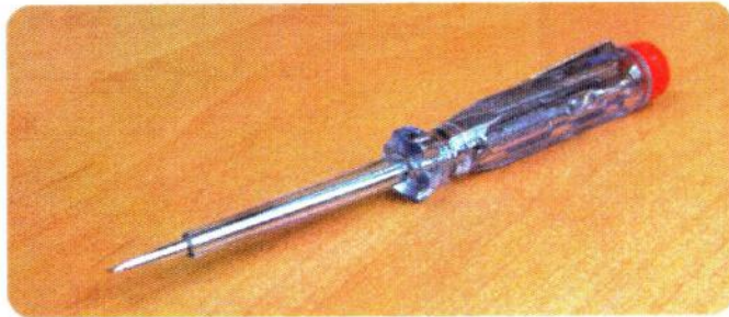
مفك براغي كاشف للتيار الكهربائي وثيقة 3
