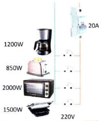
وثيقة 5 وضعيات تسبب أخطار التيار الكهربائي
